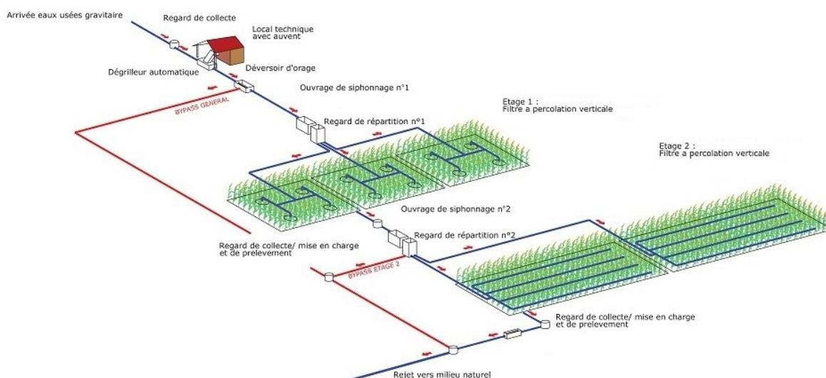
Les eaux usées passent à travers un dégrilleur automatique de manière à ce que les éléments grossiers pouvant être charriés par les eaux usées (papiers, lingettes...) soient retenus.
